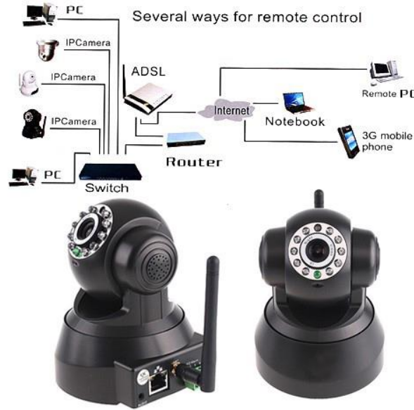
Rajah 2: Konfigurasi bagi penyambungan IP Camera
