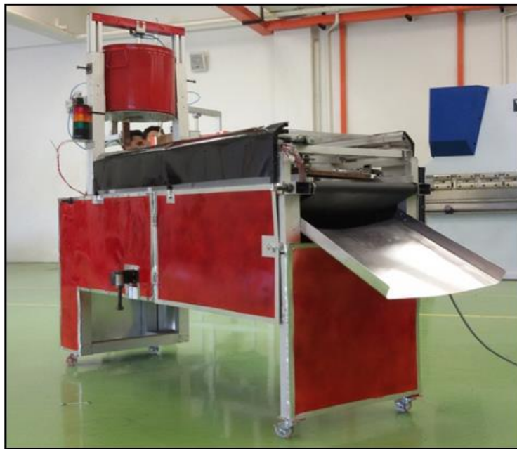
Rajah 4: Mesin Bebola Daging dengan Empat Pengelek
