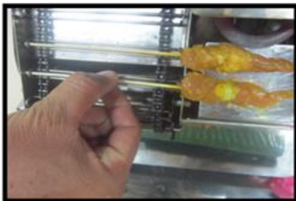
Gambar 7: Proses memuat satay ke peranti pemegang
